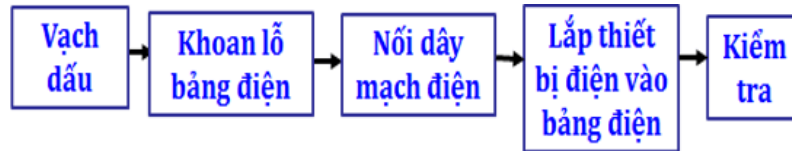
Hình 38. Quy trình lắp mạch điện bảng điện
